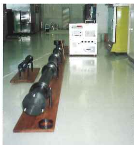
垂直入射吸音率の測定
