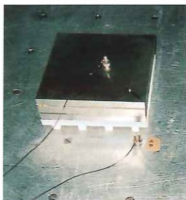
加振機を用いた動的振動特性の測定
