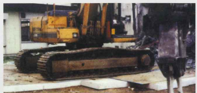
建設機械の振動対策例
