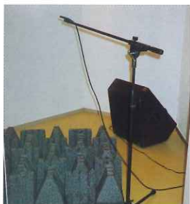
ランダム入射の吸音率測定
