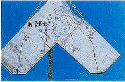
W1-B-b 壁厚 180mm 壁筋 2-D10@100ダブル 主筋 2-D13 補強筋 2-D13
