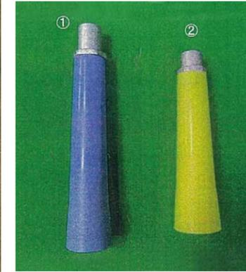
衝撃試験の試験体
