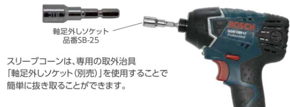
スリーブコーンは、専用の取外治具「軸足外しソケット(別売)」を使用することで簡単に抜き取ることができます。
